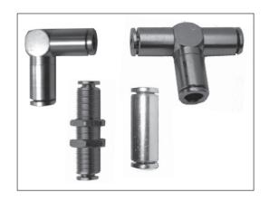
Conexiones instantáneas tipo Te, Codo, Pasachapa, Unión. Cuerpo de latón niquelado. Guarniciones de NBR. Temperatura de trabajo: -20 a 60°C. Presión de trabajo: 0 a 10 bar. Fluido: aire comprimido filtrado. Tubo a utilizar: poliuretano calibrado de diámetro 4, 6, 8, 10 y 12mm. Tipo de conexionado: instantáneo.
